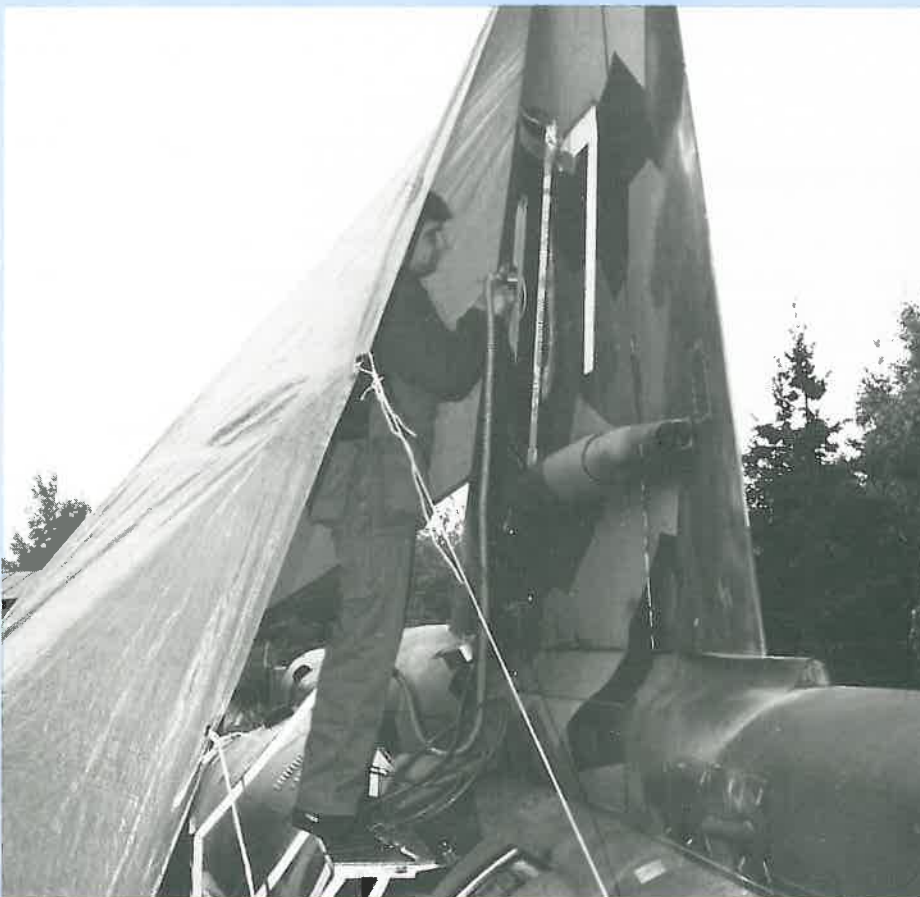
I reparationens inledningsskede tas skadad kompositstruktur bort på fenan – på bilden Per Eliasson, SMA Foto: Anders Wählström, Applied Composites
