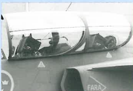
Den största synbara skillnaden mellan 39A och 39B är huvan som täcker de båda förarkabinerna
